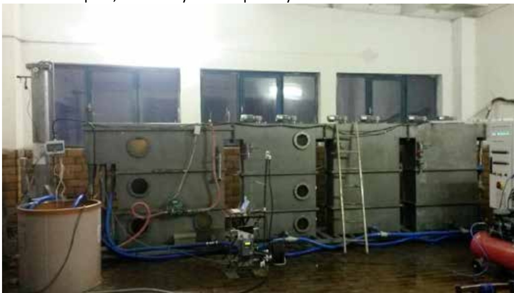
Obr. 1 Poloprovozní model flokulace a flotace na ÚV Písek
