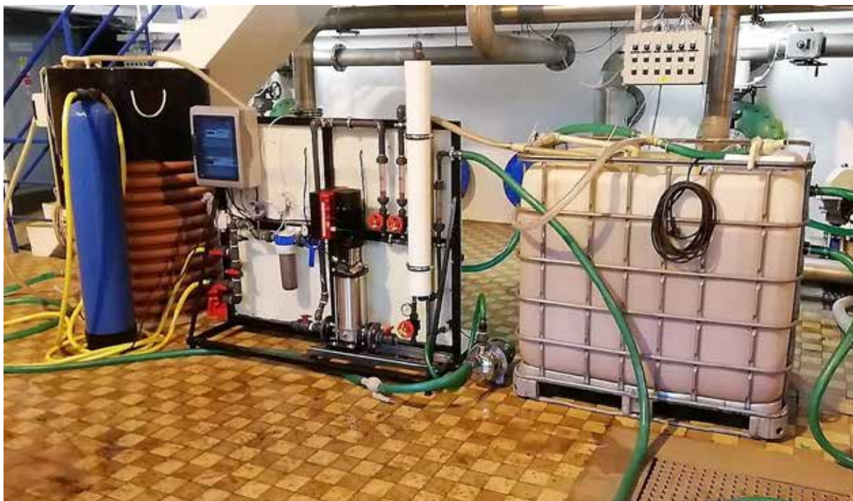
Obr. 5 Modelová jednotka pro zkoušení nanofiltrace a reverzní osmózy
