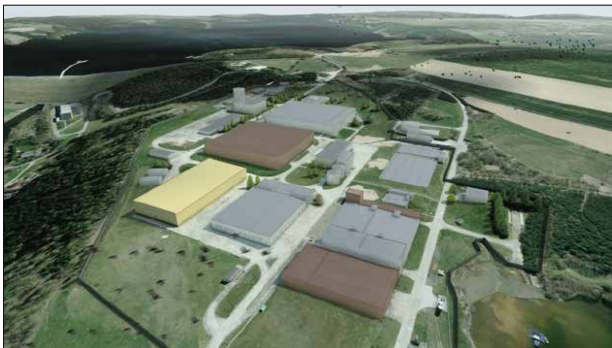
Areál ÚV Želivka s novým objektem GAU filtrace (žlutě vyznačený objekt) a dalšími objekty dotčenými realizací této akce (hnědě zvýrazněné objekty)
