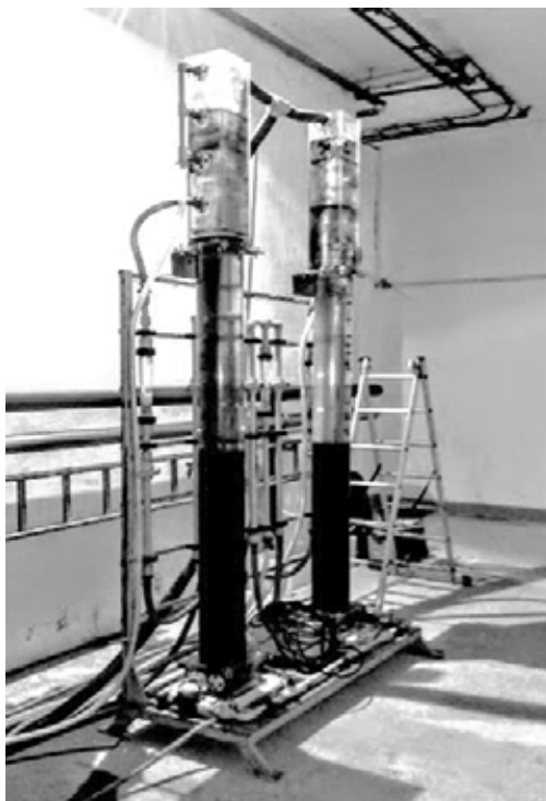
Obrázek 3. Velké poloprovozní kolony s aktivním uhlím
