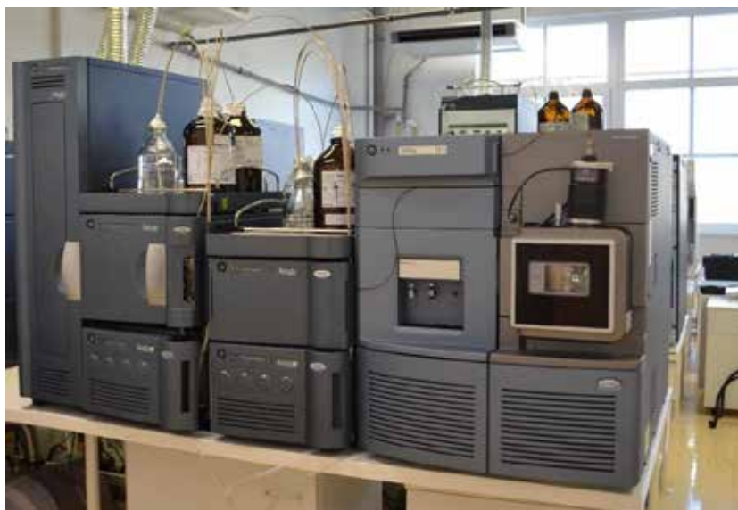
Obr. 2 LC-MS pro stanovení PFAS v ALS Czech Republic
