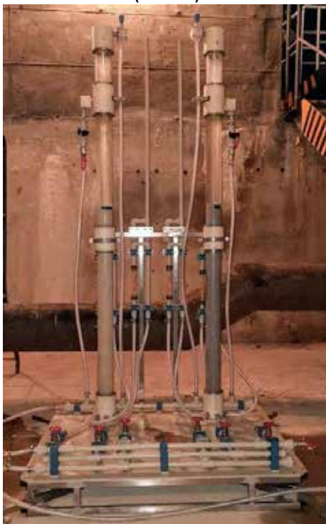
Obr. 3 Modelové kolony s drceným vápencem na ÚV Špindlerův Mlýn
