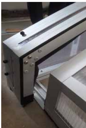
Obrázek 3: Zakrytí van filtrů. Detail ve výrobě; filtr v provozu pod zakrytím
