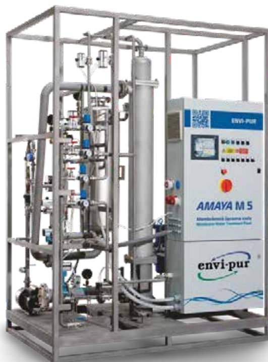
Obr. 4 Poloprovozní model membránové filtrace AMAYA
